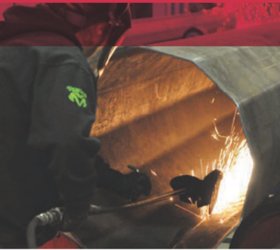
Remoción de soldaduras con el disco combinado Tiger.
