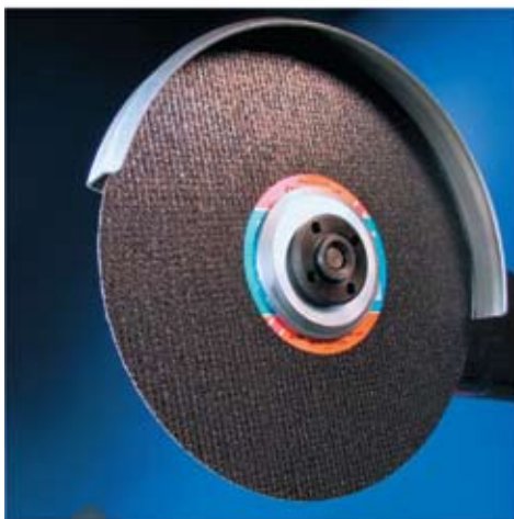
Las bridas de fijación grandes se sujetan con tuercas tensoras convencionales.
