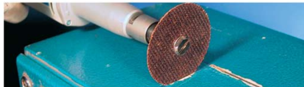
Ejemplo de uso: Apertura de orificios en cajas o depósitos.
