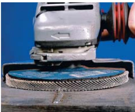
Lijado de superficie en cordones de soldadura.
