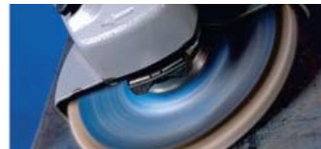
Trabajo de cordones de soldadura en láminas de acero.
