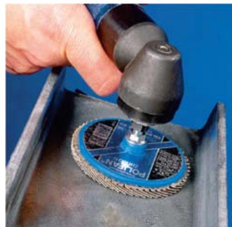
Utilización con eje flexible y empuñadura.
