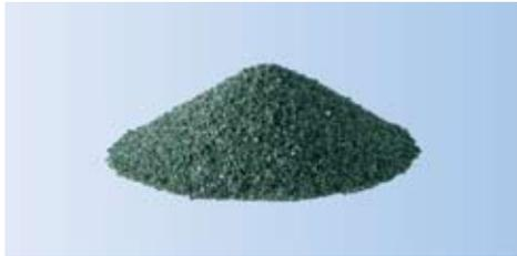
El aglomerante de poliuretano (PUR) está mezclado homogéneamente con el abrasivo. Su estructura abierta y elasticidad garantizan una buena adaptación a los perfiles y un desbaste suave y fino.
